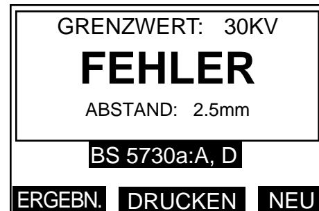
Abbildung 67a. Anzeigen für gute und fehlerhafte Ölproben. Abbildung 67b
