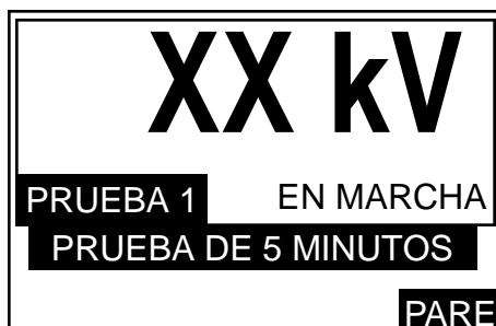
Figura 78. Pantalla de visualización de la tensión aplicada.
