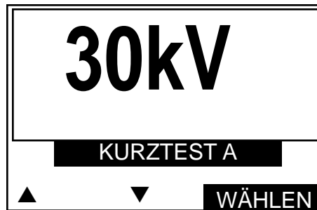
Abbildung 62: Anzeige der Spannung für Stehspannungstests
