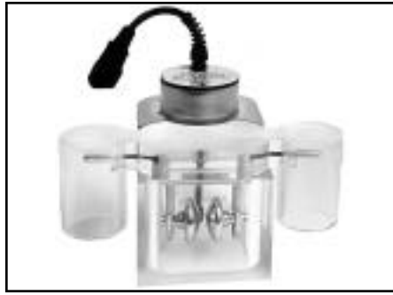
Abbildung 59: Öltestbehälter für Spezifikation ASTM D1816
