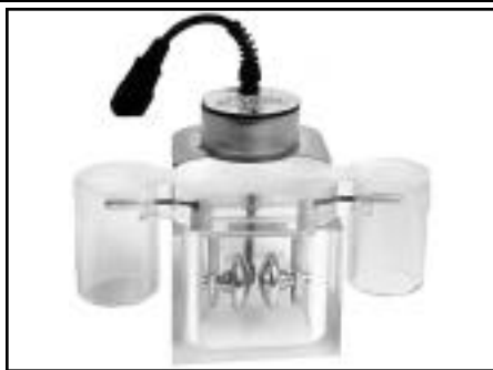
Figura 81. Recipiente de prueba de aceite para la especificación ASTM D1816.
