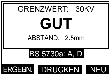
Abbildung 67a. Anzeigen für gute und fehlerhafte Ölproben. Abbildung 67b
