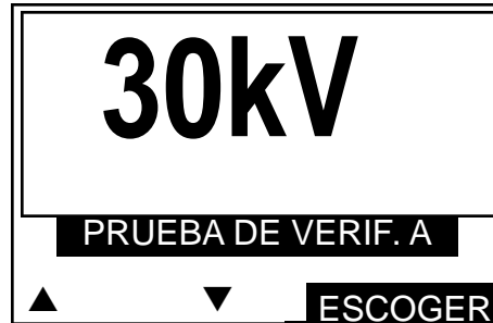
Figura 85. Pantalla de visualización del nivel de tensión de la prueba de verificación.
