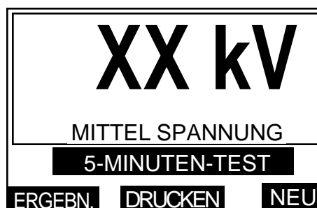
Abbildung 58: Anzeige der mittleren Durchschlagsspannung
